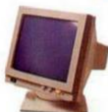
Monitor monocromo con pantalla plana antirreflexiva de alta resolución de 12" y frecuencia dual.
