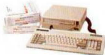
CPU con una unidad de diskette 3 1/2" (720 Kb). Con teclado y sistema operativo MS-DOS 3.2 y GW BASIC 3.2.
