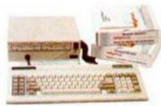
CPU con 2 unidades de diskette 3 1/2" (2 x 720 Kb). Con teclado y sistema operativo MS-DOS 3.2 y GW BASIC 3.2.
