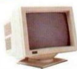
Monitor color RGB de 16 colores, cristal oscuro y pantalla de 14", totalmente compatible.
